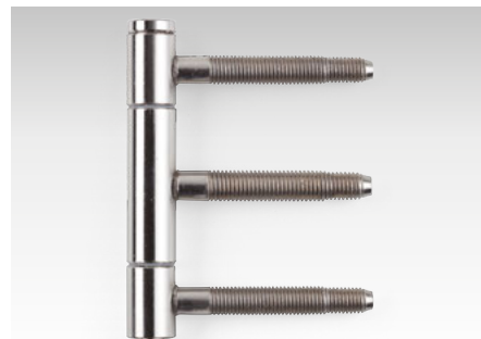
EINBOHR BAND vernickelt, 3-teilig Ø 15 mm, Höhe 100 mm
