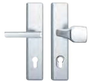
Sicura 12 (WK2) Sicura 35 (WK3) Sicherheitsdrücker (inkl. Kernziehschutz), Alu/Silber eloxiert oder Edelstahl matt. Auch für Feuerschutztüren geeignet.
