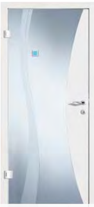
CORSO 03 Teilglastür, Oberfläche: Weiß glatt, Glas: Design 72/S (Satinato) mit Rillen- schliff, Sandstrahlung u. Glasdekorbaustein
